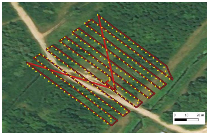
24. ábra: Az UAS (vörös) és a Safecast szenzor (sárga) útvonala összehasonlítva 25 méteres magasságban a „kocsimosó” felett
