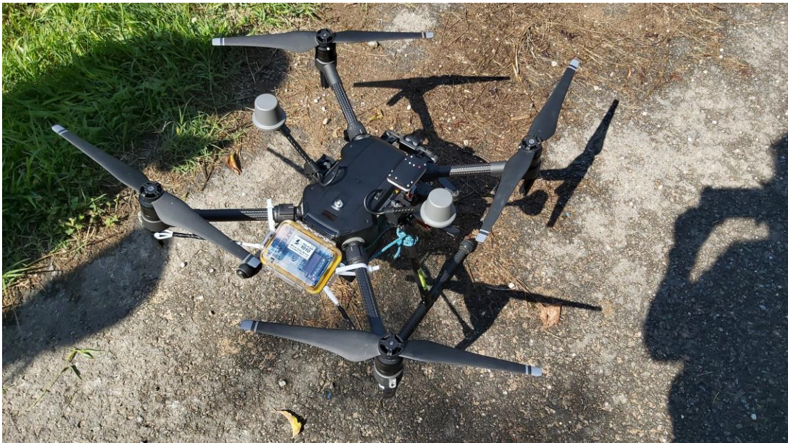
7. ábra: DJI Matrice 210 V2 RTK UAS rögzített Safecast szenzorral a teszterületen
